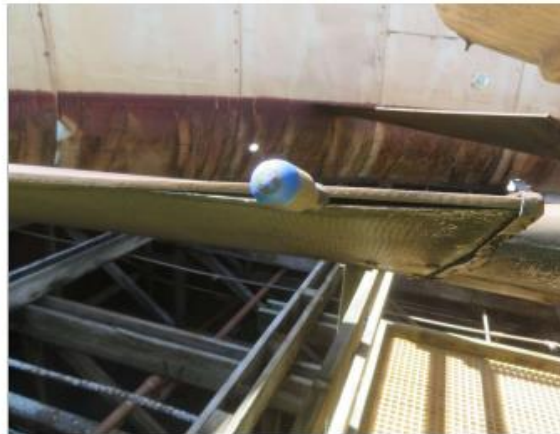
Fig. 2 Trailing Edge Fan Blade Splitting
